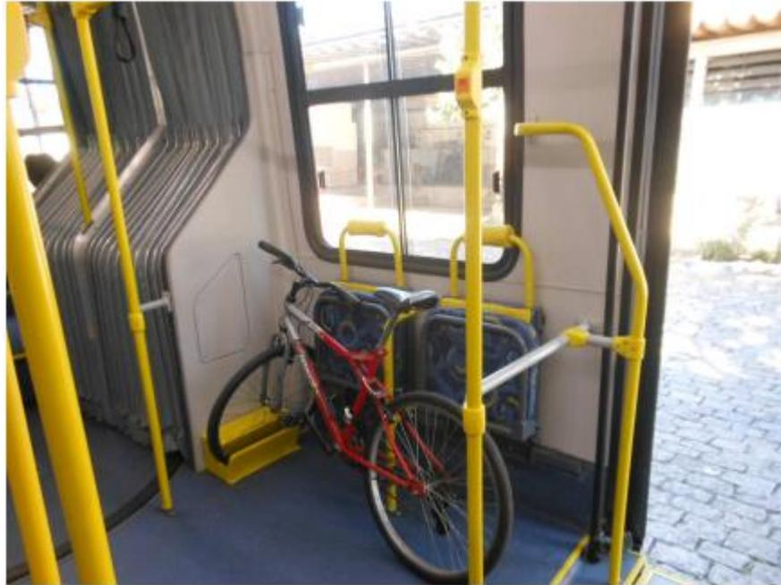
**Figura 51: Rack interno con fijo de una rueda**
